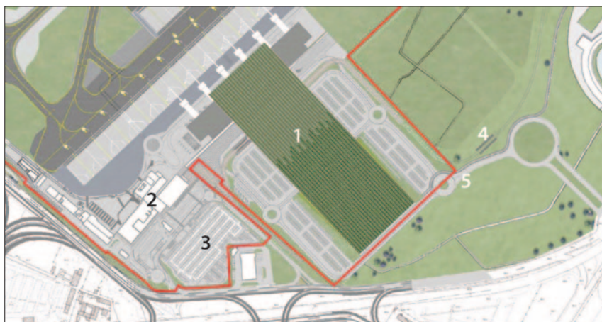
Le nuove sistemazioni previste per le due aree principali del "Vespucchi". A sinistra: l'area est, con il nuovo terminal (1) e la relativa viabilità, il nuovo ingresso est (5), la prosecuzione della tranvia per Sesto Fiorentino (4), il parcheggio multipiano (3) ed il terminal esistente (2). A destra: l'area ovest, con le strutture per l'aviazione generale (6), hangar (7), Aero club (8), hangar e officine mezzi (9), edificio catering (10), sede GdF (11), deposito carburanti (12), edificio de-icing (13).
