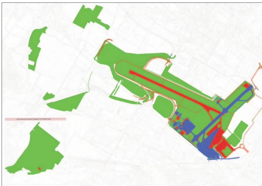
Rappresentazione delle aree permeabili e impermeabili nel nuovo assetto dello scalo e nelle aree di intervento: in verde le aree permeabili, non oggetto di consumo di suolo (circa l'85%), in blu le aree impermeabili esistenti, in rosso le nuove aree impermeabili.
